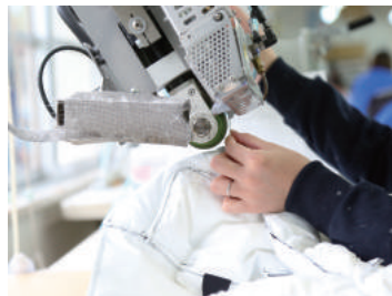
雨や冷気の侵入を防ぐシームテープ加工。見えない部分にも施される。
